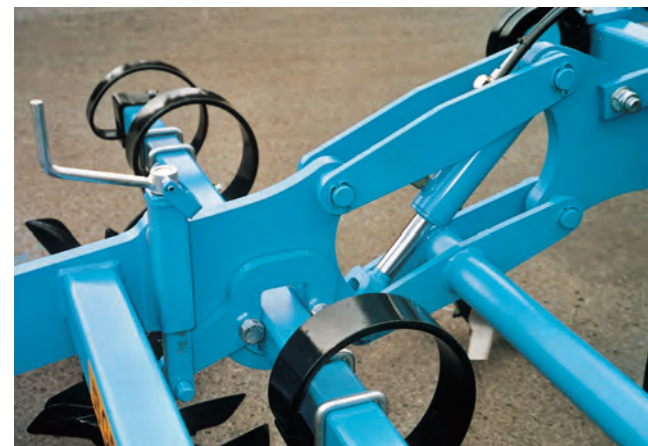
zentrale Nivellatorverstellung über Kurbelspindel
