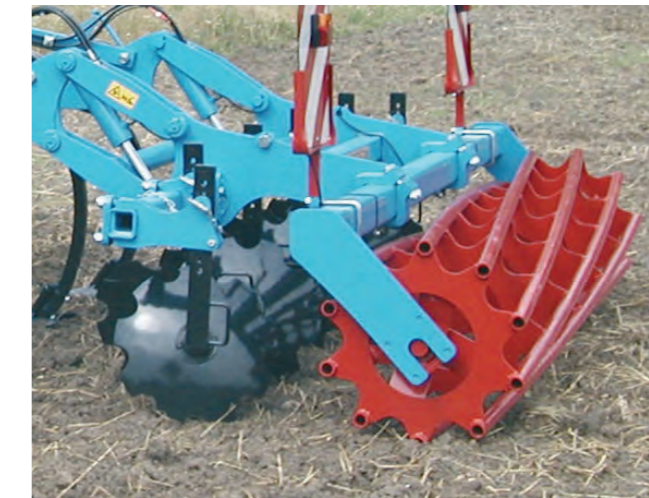
Rohrstabwalze Ø 590 mm mit Scheibennivellator
