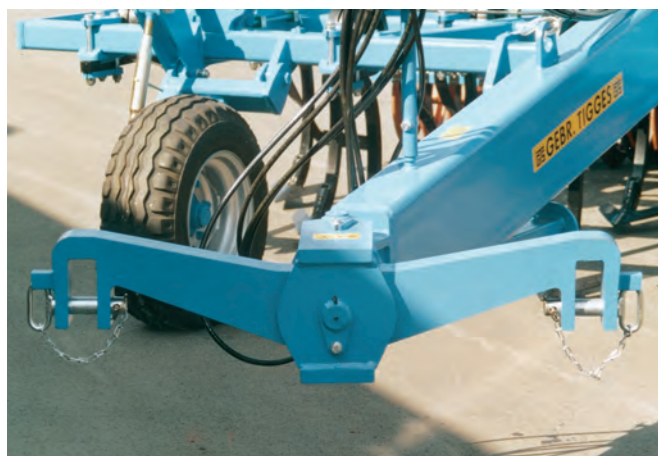
Kardanische Unterlenkeranhangung (Kat. III)
