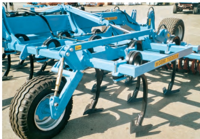
Stützradverstellung über Spindel u. Synchrongestänge
