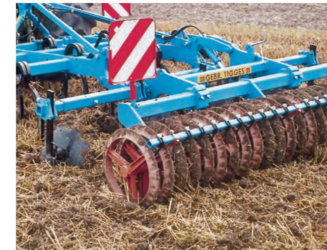
Packerwalze Ø 550 mm mit Scheibennivellator
