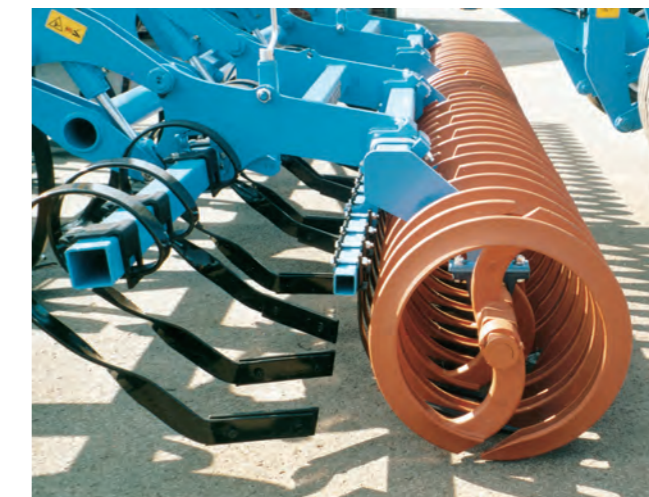
Spiroflex-Walze Ø 600 mm mit Schleppzinkennivellator
