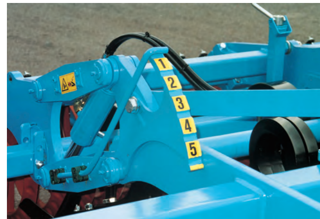
hydraulische Arbeitstiefenverstellung mit Tiefenanzeige
