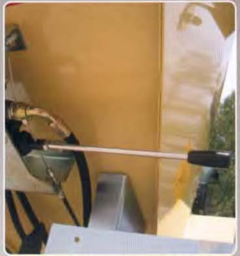
Sistema di sblocco emergenza di introduzione Reset system to release emergency stop Système de remise pour débloquer l'arrêt de sécurité Sistema de desbloqueo para de emergencia insertado Wiederzuschaltung der Einzugswalze nach dem Notstop Systeem om de noodstop weer vrij te maken
